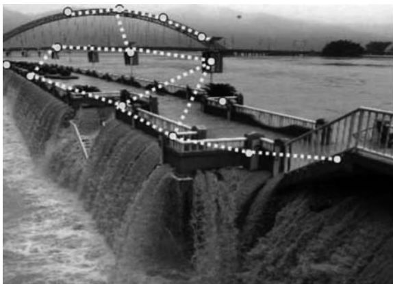
图 5.17 基于无线传感器网络的桥梁结构监测系统示意图
