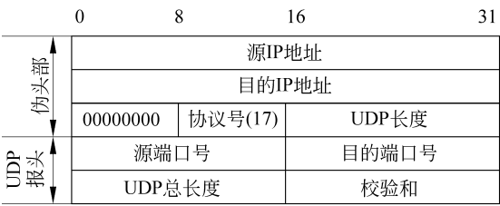
图 5-12 UDP 校验和校验的伪报头与报头的结构
