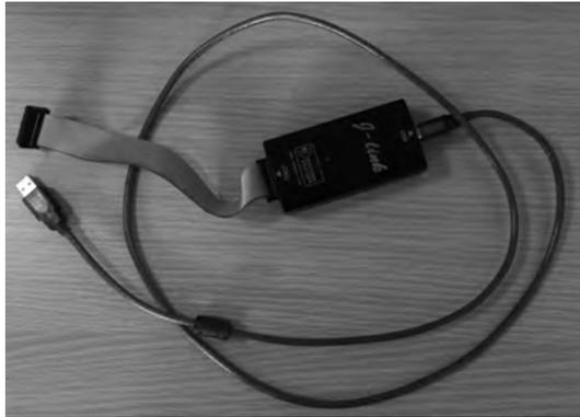
图 3-75 JLINK V8 仿真器及其相关数据连接线
