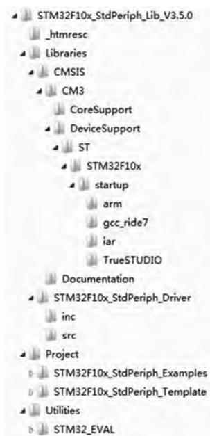
图 3-4 ST 官方固件库文件夹的结构
