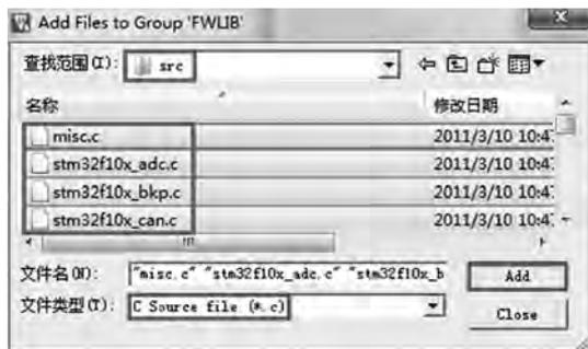
图 3-43 向工程的 FWLIB 子文件夹中添加文件
