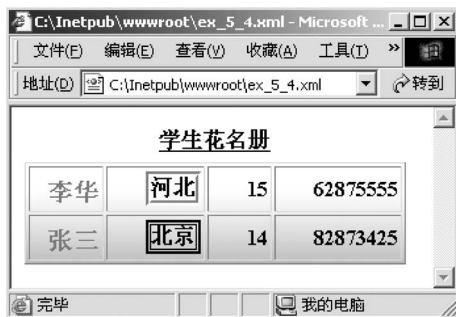
图 5-5 使用 CSS 将 XML 文档按表格输出
