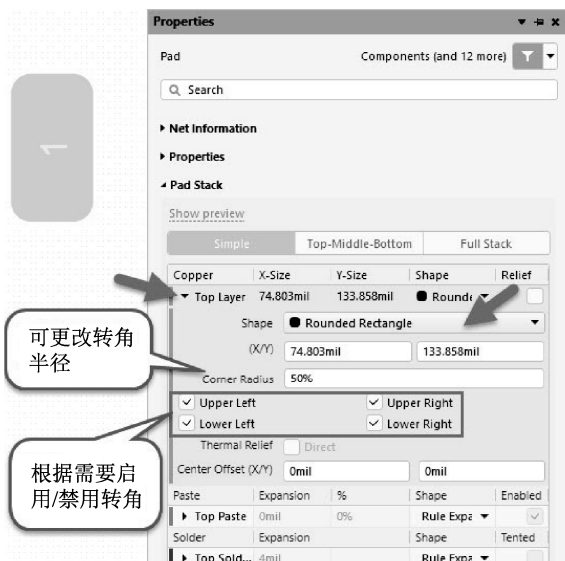
图 3-69 焊盘圆角/倒角处理
