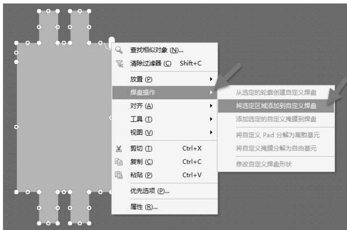
图 3-64 放置“实心区域”创建异形焊盘
