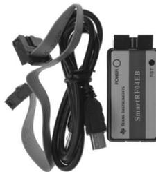
图 1-9 SmartRF04EB 仿真器及数据连接线
