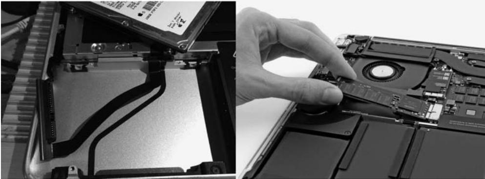
图 5-28 拆卸 MacBook Pro 中的硬盘(左侧为 SATA 机械硬盘,右侧为 PCIe 固态硬盘)
