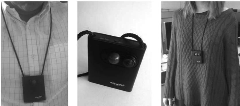
图 3-2 SenseCam 可穿戴式视觉传感设备及穿戴示例
