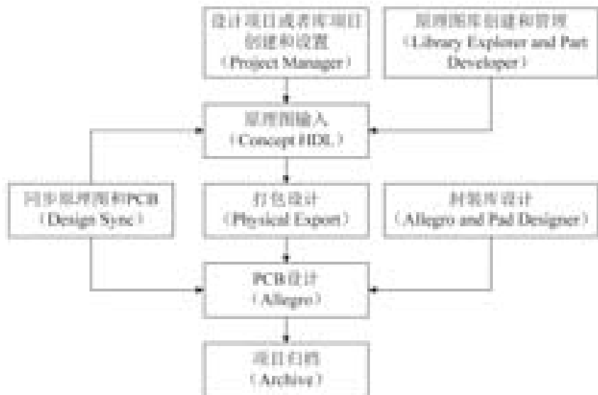
图 3-16 Cadence 的 PCB 系统设计流程示意图
