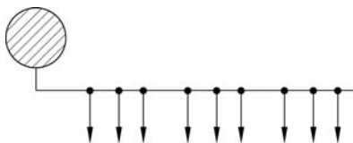
图 3.4.9 树干式配电线路图 1
