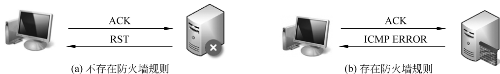
图 5-7 TCP ACK 扫描工作原理
