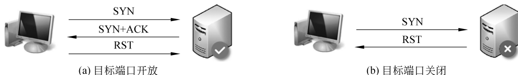
图 5-6 TCP SYN 扫描工作原理
