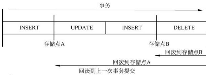
图 5-3 回滚保存点的执行流程
