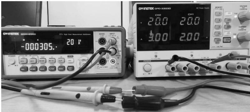
图 3-2-20 测试线连接图
