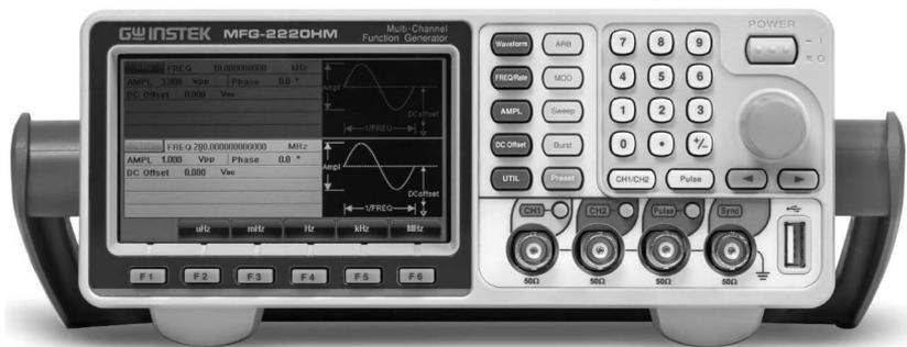
图 3-2-1 多通道函数信号发生器 MFG-2220HM
