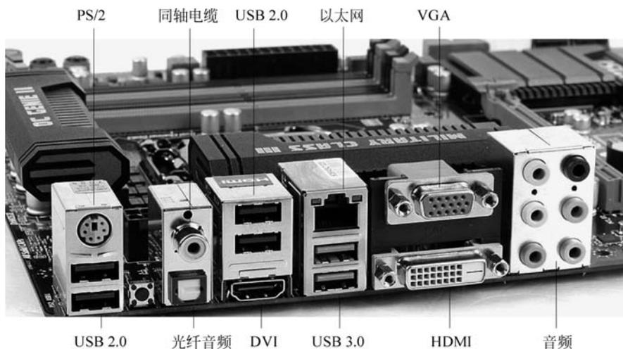
图 3-23 计算机主板提供的常见 I/O 设备接口类型
