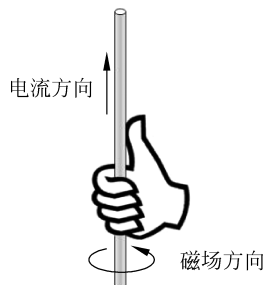
图 5-7 判定通电导线周围磁场方向的右手定则
