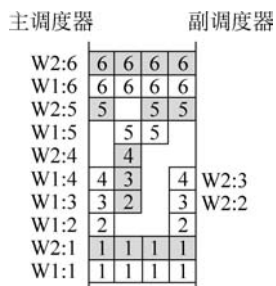
图 3-21 不同线程束不同 PC 线程重组和合并示例
