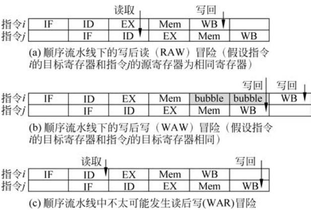
图 3-31 顺序流水线下的 3 种数据相关性冒险
