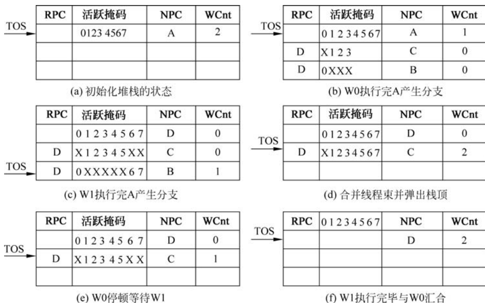
图 3-16 线程块压缩技术下 SIMT 堆栈的更新过程
