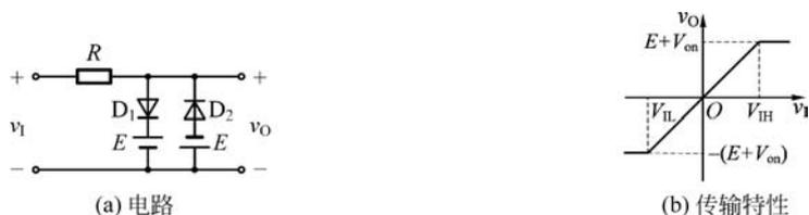
图 5.25 二极管双向限幅电路
