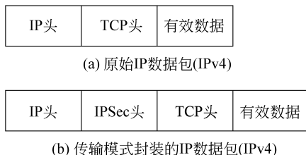
图 3-2 传输模式封装的 IP 数据包结构
