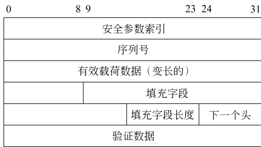
图 3-10 ESP 协议包结构
