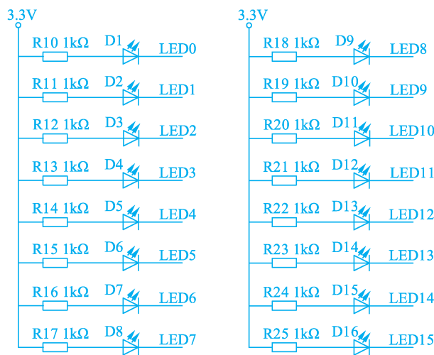
图 3-12 流水灯电路原理
