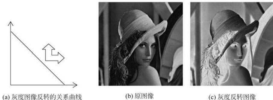
图 3.1 灰度图像反转原理及示例
