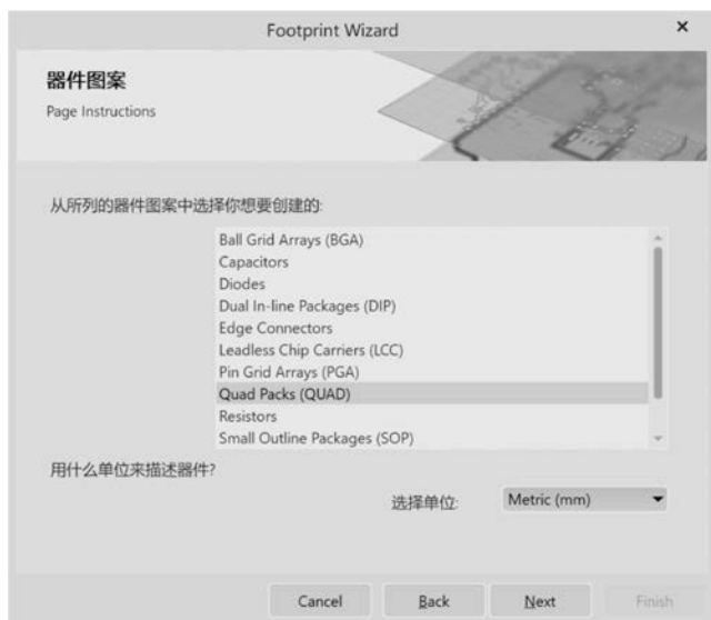
图 5-26 元件封装样式选择界面
