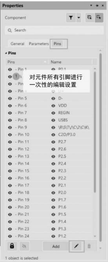
图 5-11 设置所有引脚
