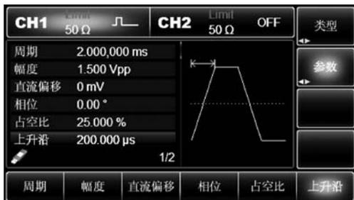
图 1-7 脉冲波参数的设置
