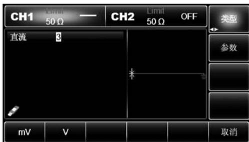
图 1-8 直流电压值的输入
