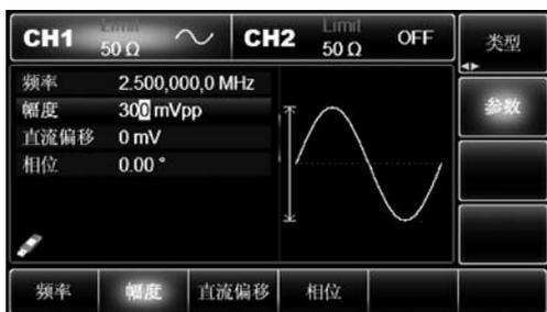
图 1-4 幅度值的输入
