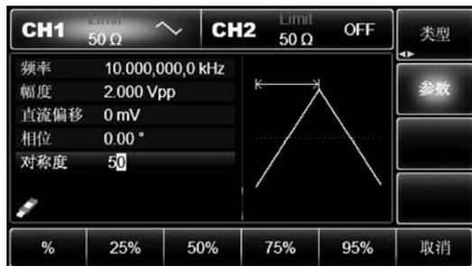
图 1-9 斜波参数的设置
