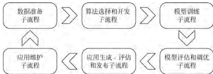
图 3-3 人工智能应用开发全流程所包含的几个主要子流程
