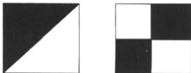
图 3.26 两幅图像内容不同但具有相同的直方图
