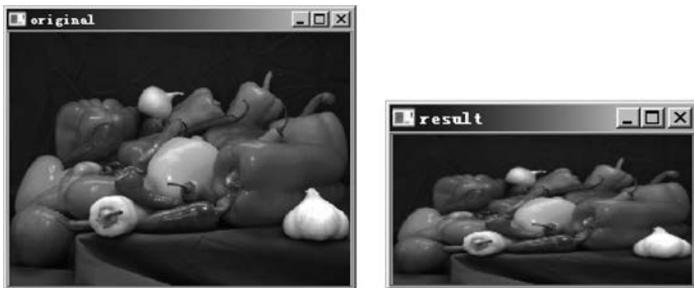
图 3.46 `resize()` 函数图像缩放
