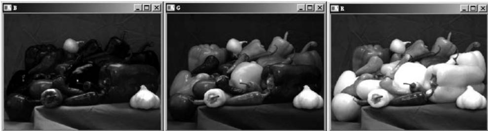
图 3.33 RGB 图像通道拆分
