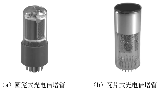
图 3.5 光电倍增管实物图
