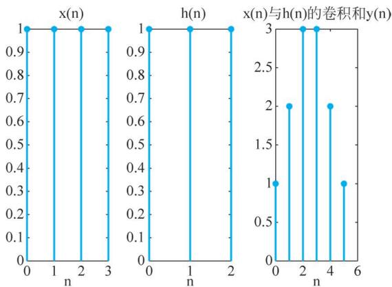
图 5-4-5 离散序列零状态响应卷积图
