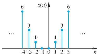
图 5-1-1 离散信号  $x(n)$  的波形表示
