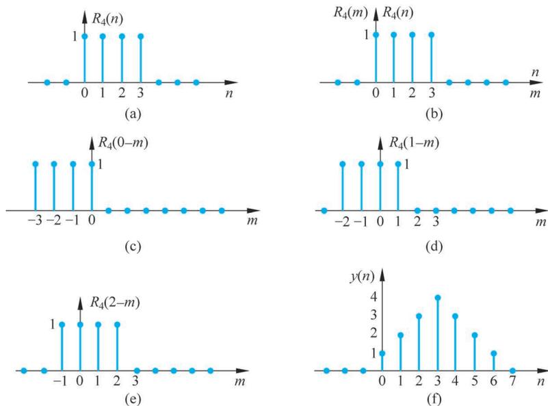
图 5-4-1 图解法计算卷积和的示意图
