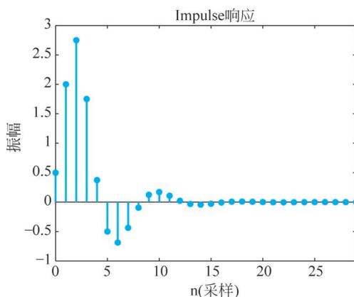
图 5-3-1 离散系统的单位样值响应
