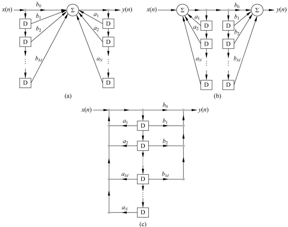
图 5-2-8 离散时间系统的一般结构形式——模拟图
