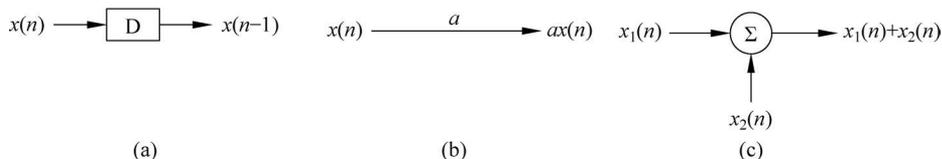
图 5-2-5 离散时间系统的基本运算单元
