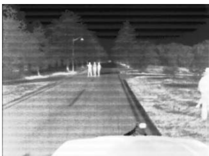
图 3-1 电源纹波对某红外热像仪的条纹干扰
