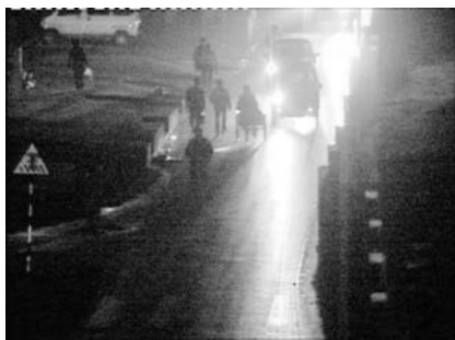
图 3-2 夜晚光照不足时某图像传感器的噪声
