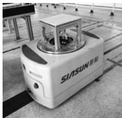
图 3-20 沿固定轨迹移动的机器人
