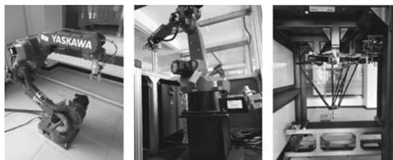
(a) 固定在地面 (b) 固定在工作台上 (c) 固定在横梁上
