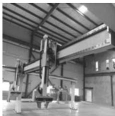
图 3-19 横梁式移动机器人
