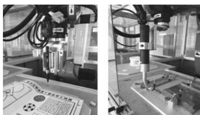
(a) 绘图机器人 (b) 焊接机器人
