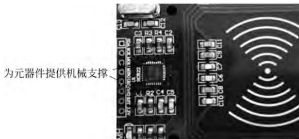
图 5-2 印制电路板为元件提供机械支撑
