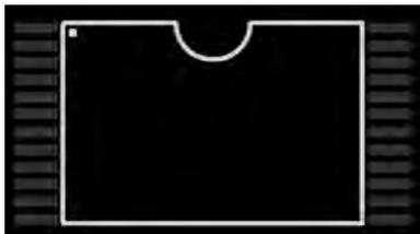
图 5-20 TSOP8×14 封装
