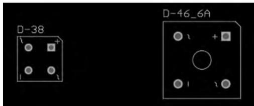
图 5-50 整流桥 D-38 封装和整流桥 D-46\_6A 封装
