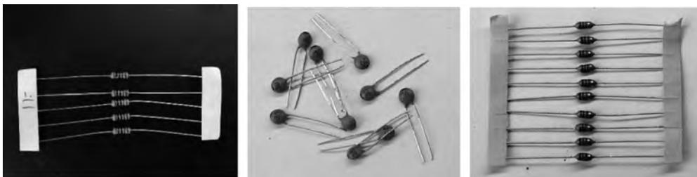
图 5-54 引脚间距为软尺寸的元件
