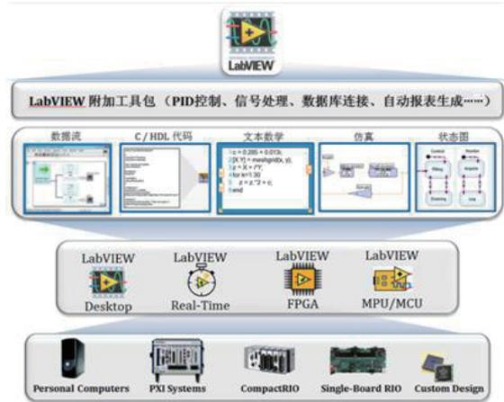
图 1-3 LabVIEW 图形化设计平台结构
