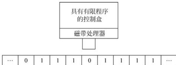
图 3.2 具有打孔磁带的图灵机
