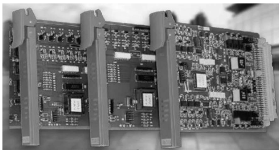
图 3-14 I/O 模块板卡
