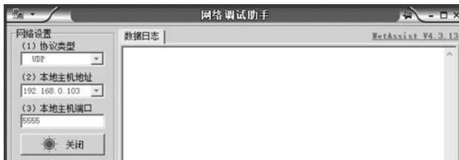
图 5-4 设置 UDP 监听的 IP 地址和端口
