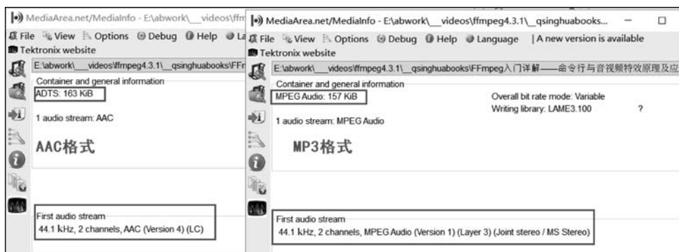
图 5-47 通过 MediaInfo 比较 AAC 格式与 MP3 格式的区别
