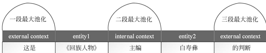
图 5.4 分段最大池化层模型
