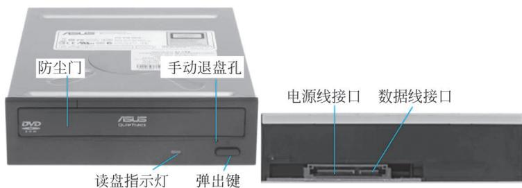
图 5-18 光驱的外观结构
