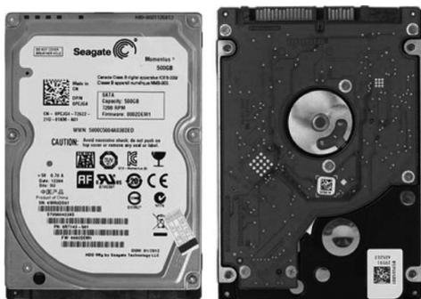
图 5-4 机械硬盘的外观结构
