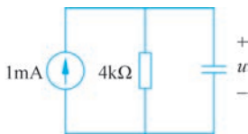
图 3.4.26 例 3.10 图解单独立节点电路
