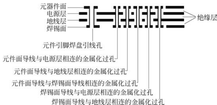
图 3-16 多层板的结构
