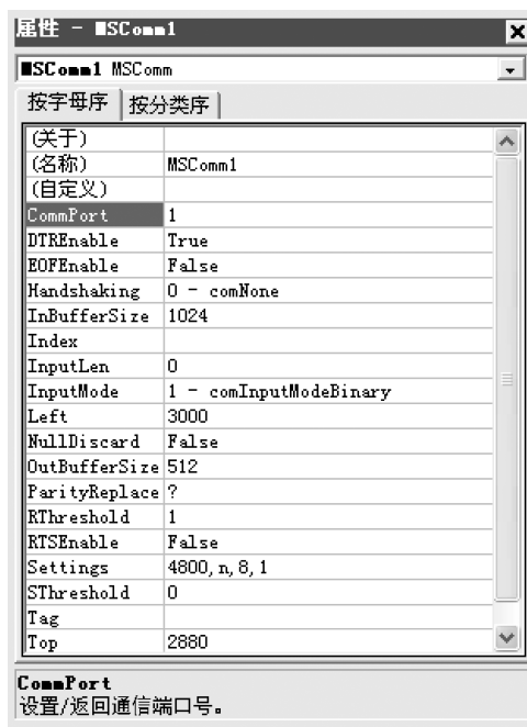
图 14-22 MSComm1 控件的属性
