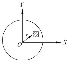
图 3-1 圆盘绕过圆心轴惯性矩
