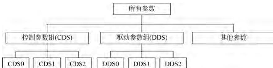
图 3-7 MM4 系列变频器参数结构图
