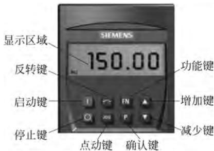
图 3-14 MM4 系列变频器基本操作显示面板
