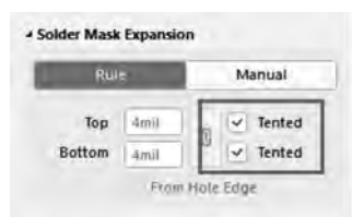
图 5-57 单个过孔盖油设置
