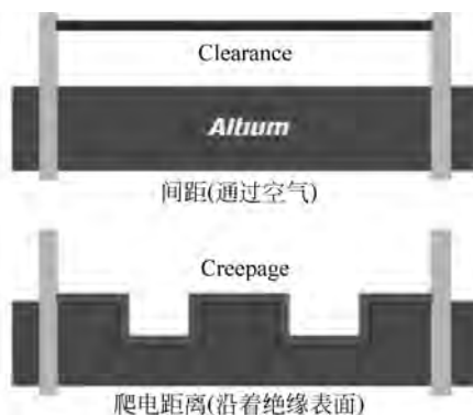
图 5-27 Clearance 和 Creepage 的区别
