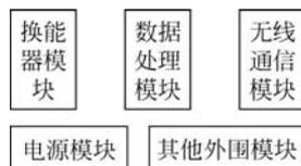
图 5.7 无线传感器网络结点的结构组成
