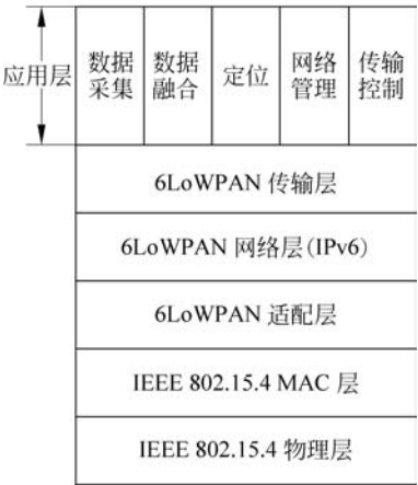
图 3-38 6LoWPAN 协议的体系结构
