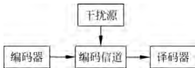
图 3.2 关注编码信道的通信系统简化模型
