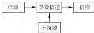
图 3.3 关注等效信道的通信系统简化模型
