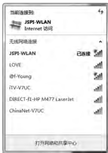
图 5-7 同一个移动终端探测到的多个 SSID
