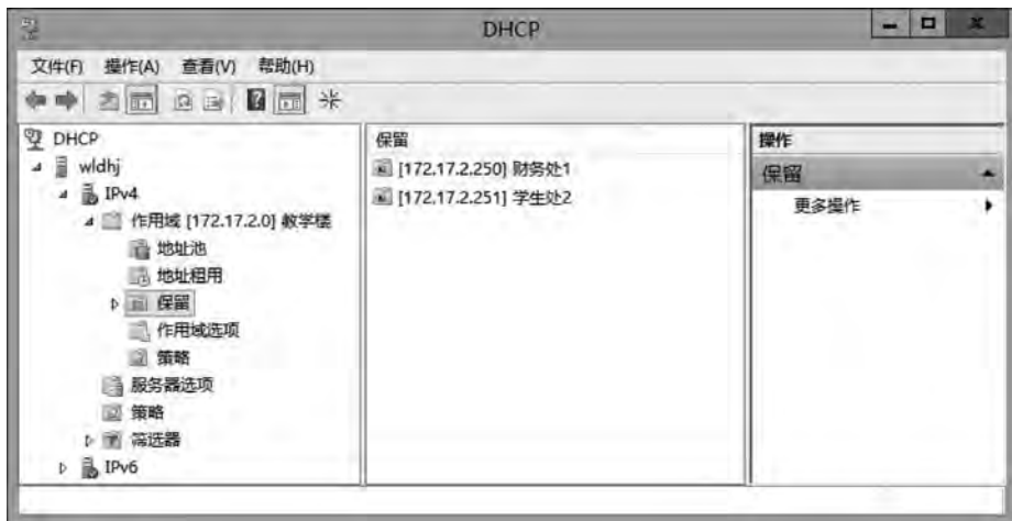
图 5-21 显示已创建的客户端 IP 地址与 MAC 地址的绑定关系
