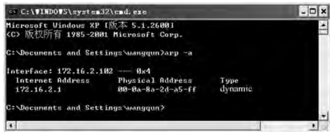
图 5-15 使用“arp -a”命令显示网关 IP 地址对应的 MAC 地址
