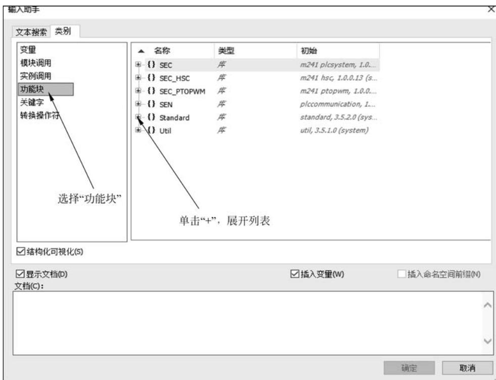
图 5-4 SoMachine 中输入助手对话框
