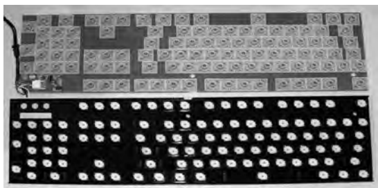
图 3.4 导电橡胶式键盘内部结构
