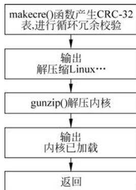
图 5.12 decompress\_kernel 解压缩函数流程
