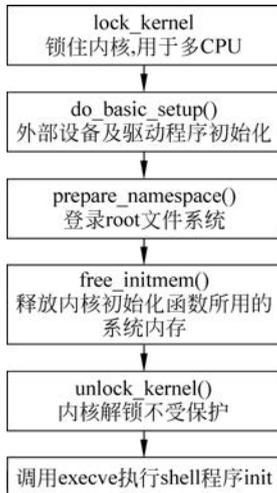
图 5.14 `init` 函数流程
