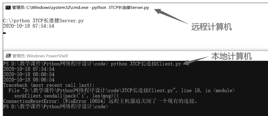
图 3-7 没有开启保活机制时的运行过程
